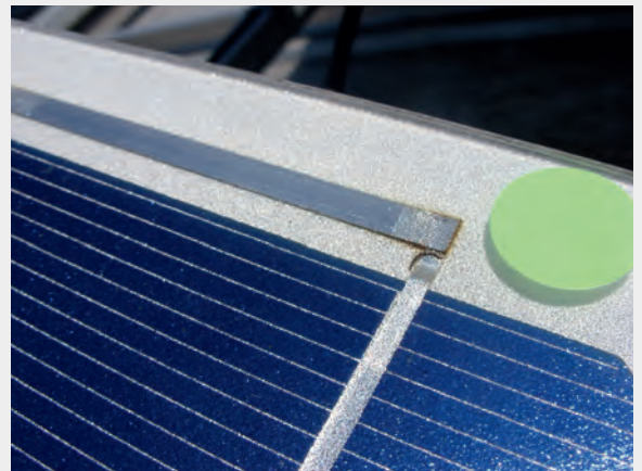
Bild 9 | Heiße Lötverbindung in einem PV-Modul
