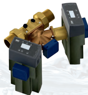
Bild 5b | Zwei Leckagedetektoren Safe-T-connect lassen sich über einen Zweifachverteiler zu einer Duplexeinheit kombinieren. Dadurch kann der Volumenstrom verdoppelt werden.
