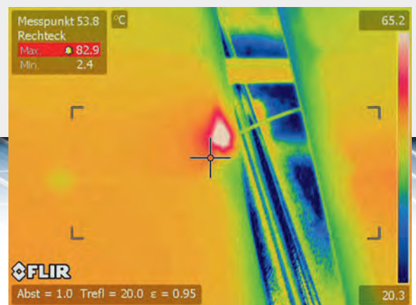
Bild 10 | Die gleiche Lötverbindung im Infrarotbild
