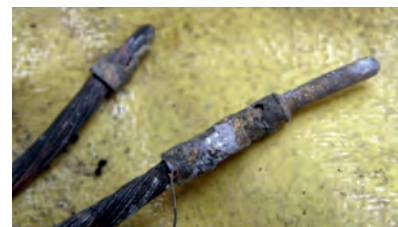
Bild 13 | Reste zweier Steckverbinder aus dem Schutt eines Wohnhauses. Der rechte Stecker war in Ordnung, der linke ist durch einen Lichtbogen stark beschädigt worden. Der Kontaktstift ist verdampft, die Crimpung ist noch teilweise erhalten. (Foto: IFS)
