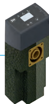
Bild 5a | Der Leckagedetektor Safe-T-connect bildet die wichtigste Grundeinheit des Baukastens. Unten im Bild befindet sich der wasserführende Teil des Leckagedetektors, mit einer Schaumpolystyrolhülle verkleidet. Oben ist die Steuereinheit erkennbar, die elektronische Steuerung, Stellmotor und Internetanschluss enthält.
