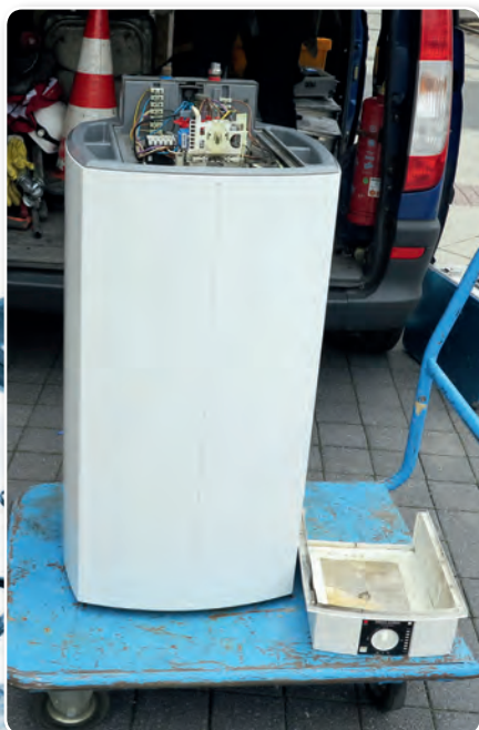
Bild 1 | Der schadensursächliche Warmwasserbereiter beim Transport ins IFS
